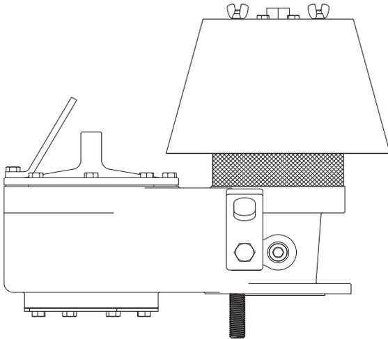
SPRING LOADED PRESSURE / WEIGHT LOADED VACUUM
