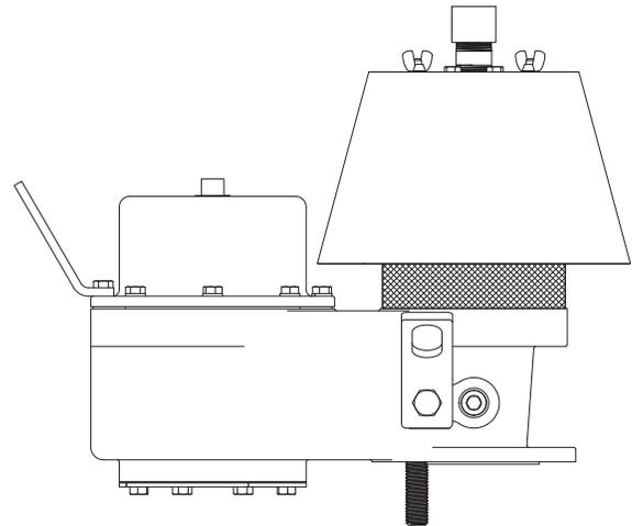
WEIGHT LOADED PRESSURE / SPRING LOADED VACUUM
