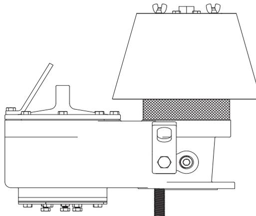
SPRING LOADED PRESSURE / WEIGHT LOADED VACUUM
