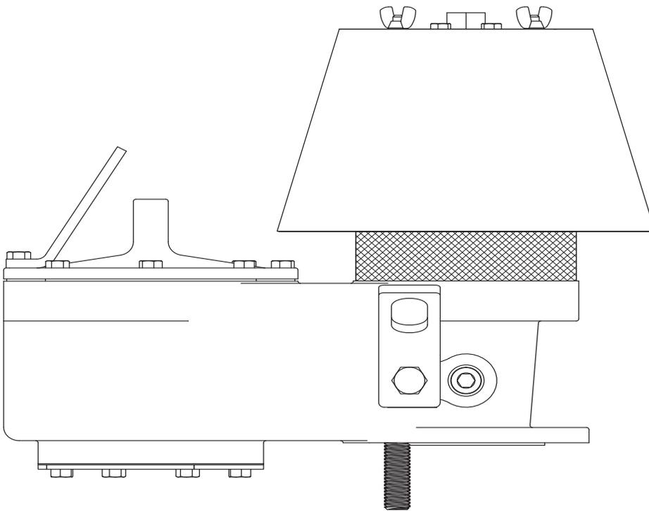
SPRING LOADED PRESSURE / WEIGHT LOADED VACUUM
