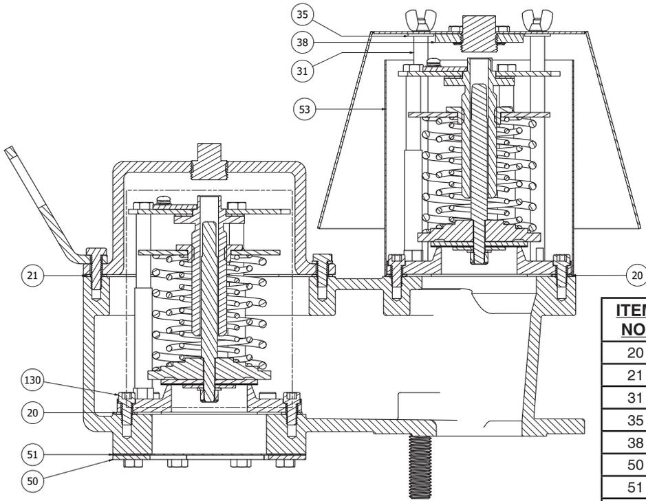
SPRING LOADED PRESSURE / SPRING LOADED VACUUM
