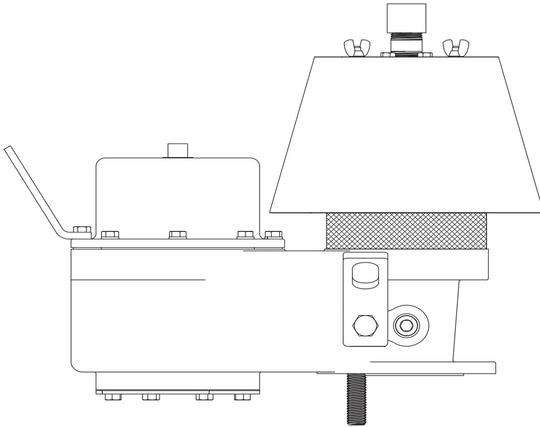
WEIGHT LOADED PRESSURE / SPRING LOADED VACUUM
